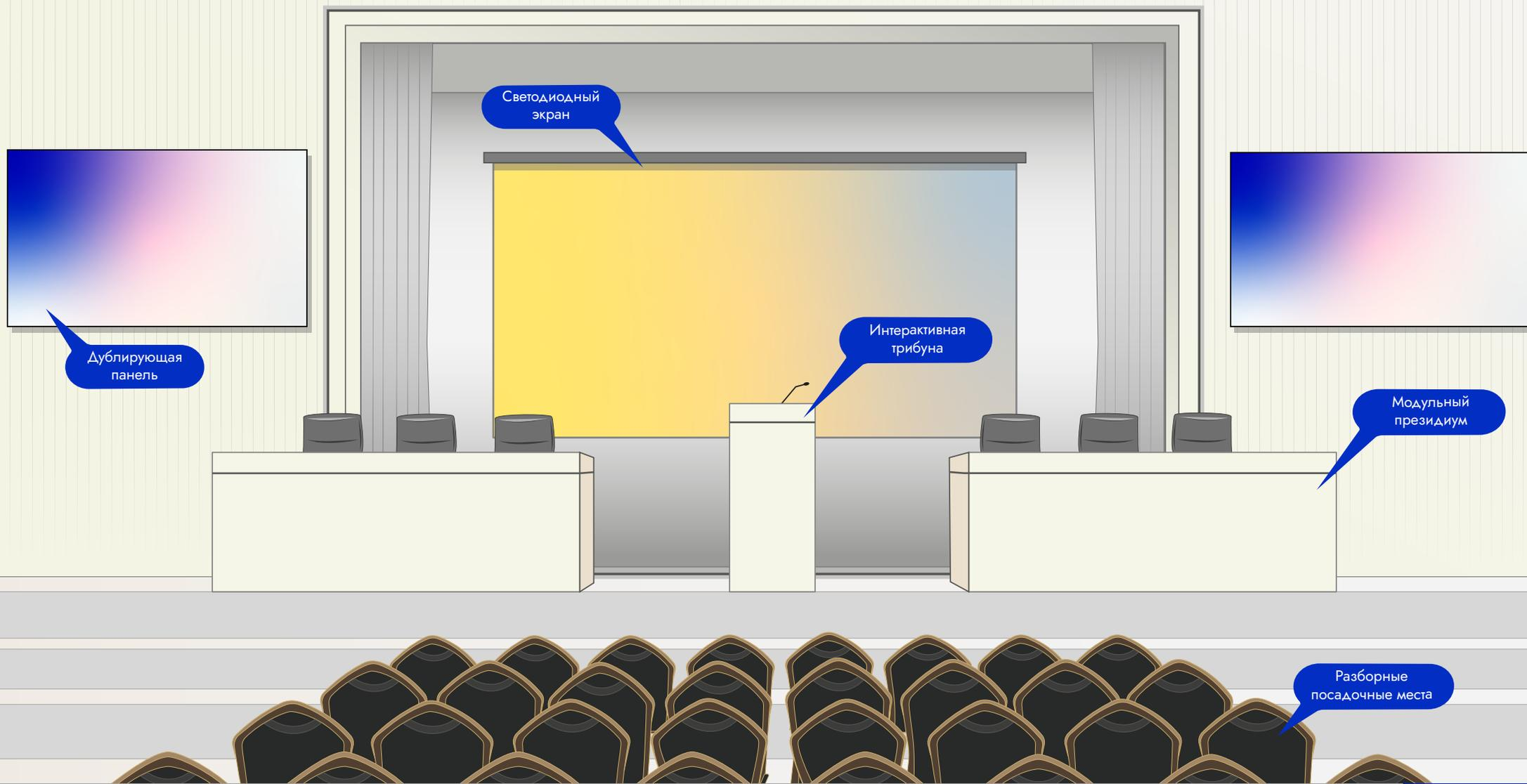
Современный актовый зал с системой видео отображения и системой озвучивания. Установлен моторизованный экран для проектора на направляющих, что дает возможность изменять глубину сцены в зависимости от типа мероприятия. Основной экран продублирован ЖК-панелями. Установлены шторы блэкаут и контроллер управления освещением. Потолочные видекамеры с сервером записи для проведения ВКС и записи мероприятий.
